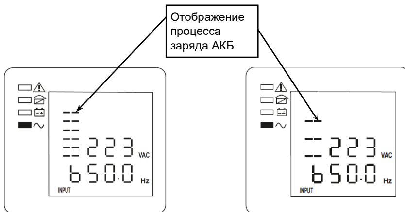
Рисунок 21 — ЖК-дисплей: форсированный (ускоренный) заряд АКБ
